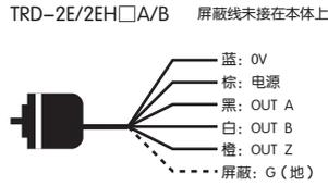
■ 线驱动方式接线定义
