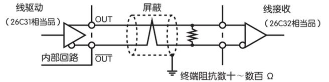
● 线驱动器输出的数据传送回路符合RS-422A标准, 用双绞线电缆传送距离最大可达1200m
