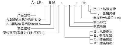
每转输出脉冲数(P/r):玻璃光栅盘:1~8192(可细分至80000) 金属光栅盘:1~1024
